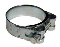
Die Gelenkbolzenschellen ABA Robust werden aus hochwertigem Kohlenstoffstahl gefertigt. Alle Teile werden vor der Montage einzeln feuerverzinkt. Diese kräftigen Schellen verfügen zur Schonung der Schlauchdecke über aufgebogene Bandkanten. Zwei massive Zylinder sorgen für eine optimale Führung der Sechskantschraube. Die Brücke ist mit zwei Klemmpunkten gegen ein mögliches Herausfallen gesichert.
